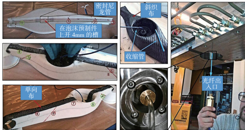
图1 FBG传感器埋入汽车控制臂
